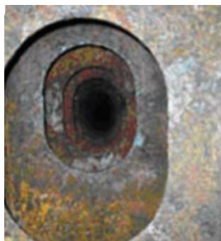
Apstrāde ar FLUID FILM Liquid A 25 µm
