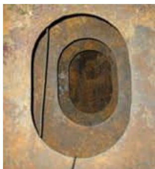
Pēc mazgāšanas ar augstspiediena strūklu ar min. 350 bar spiedienu
